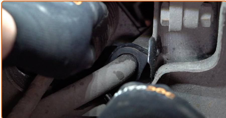
Entfernen Sie die Stabilisatorbuchsen.
