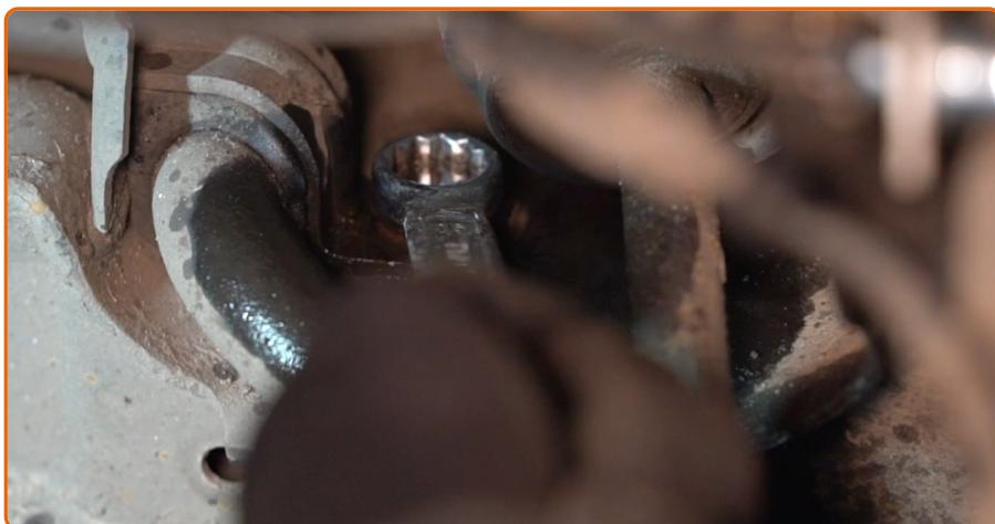
Schrauben Sie die Befestigungen der Stabilisatorbuchsenhalter heraus. Verwenden Sie Ring-Gabelschlüssel Nr. 16. Verwenden Sie Stecknuss Nr. 16. Verwenden Sie einen Ratschenschlüssel.
