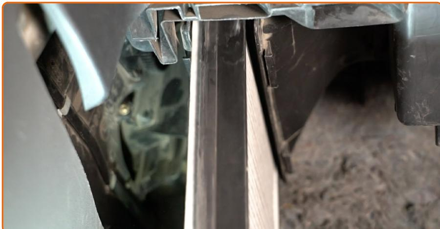
Entfernen Sie das Filterelement aus dem Filtergehäuse
