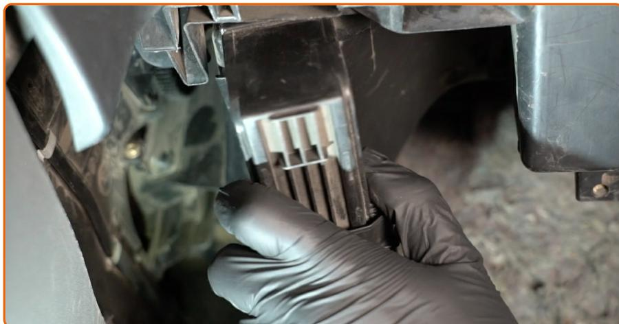
Lösen Sie die Clips der Innenraumfilterabdeckung.
