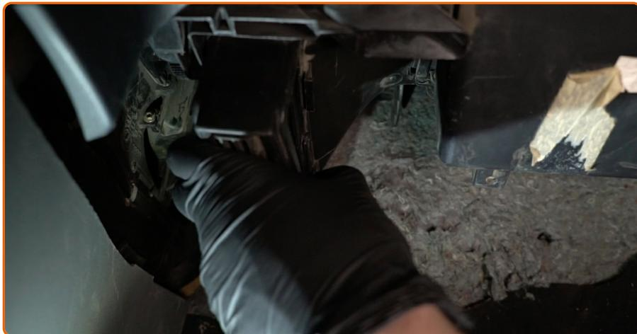
Installieren Sie den Gehäusedeckel des Innenraumfilters.
