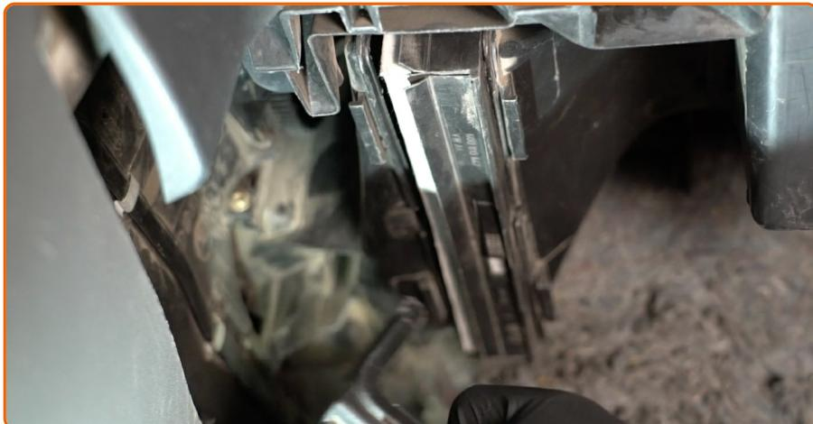
Entfernen Sie den Gehäusedeckel des Innenraumfilters.
