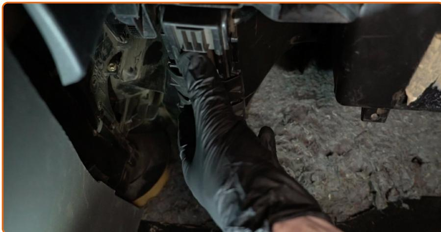
Befestigen Sie die Clips der Innenraumfilterabdeckung.
