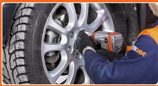
Lösen Sie die Radschrauben am auf dem Boden stehenden Fahrzeug
