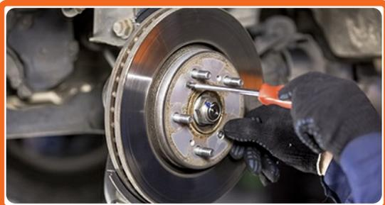
Lösen Sie die Bremsscheiben-
