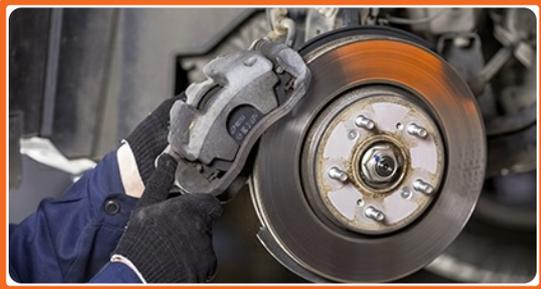
Entfernen Sie den Bremssattel.
