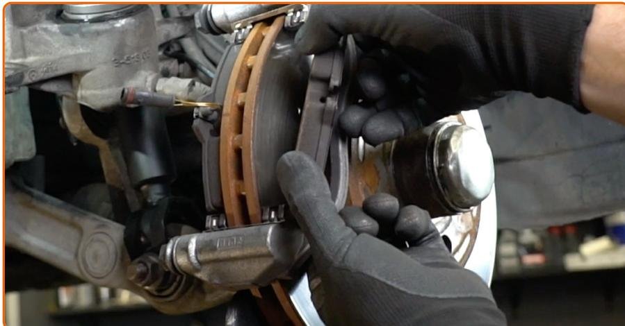
Entfernen Sie die Bremsbeläge.
