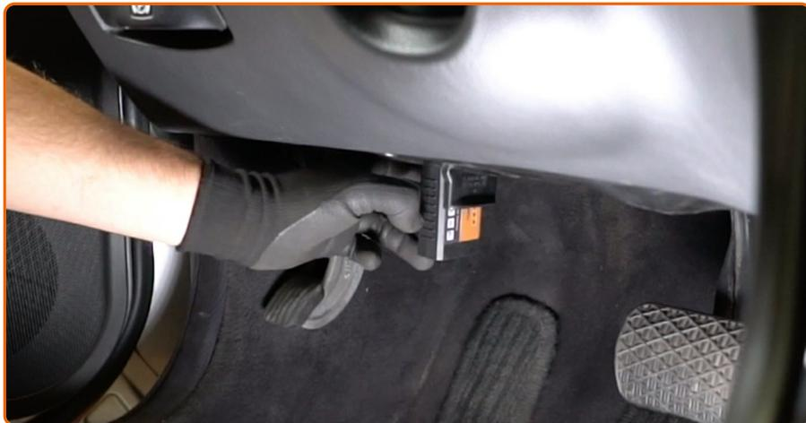
Bringen Sie das Wartungsgerät an und stellen Sie die elektrohydraulischen Bremsen (SBC) in den Wartungsmodus.
