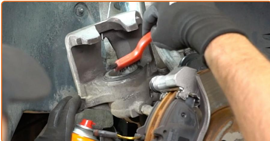
Behandeln Sie den Bremsattel-Kolben. Verwenden Sie eine Nylon-Reinigungsbürste.
