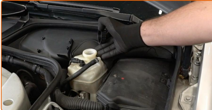
Schrauben Sie die Kappe des Bremsflüssigkeitsausgleichsbehälters ab.
