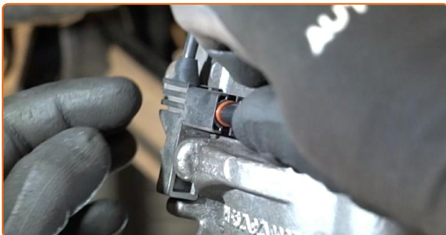
Bringen Sie den Steckverbinder des Verschleißsensors der Bremsbeläge an.
