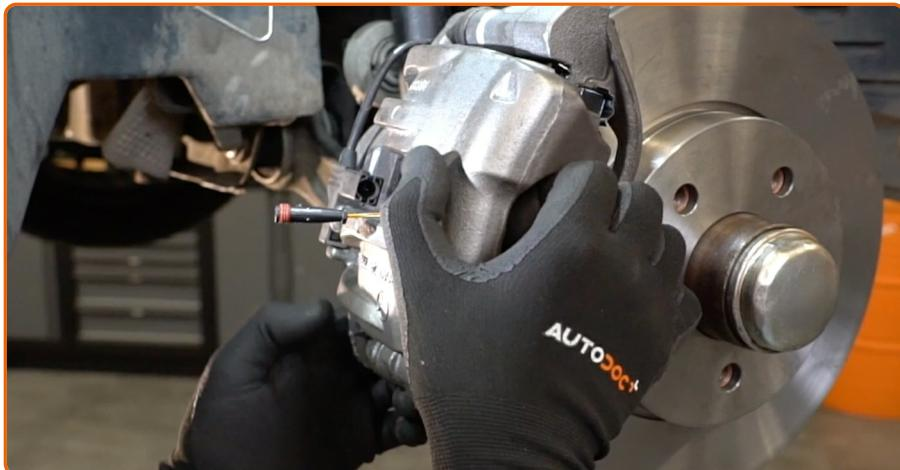
Installieren Sie den Bremssattel und fixieren Sie diesen. Verwenden Sie Ring-Gabelschlüssel Nr. 17. Verwenden Sie Stecknuss Nr. 13. Verwenden Sie einen Drehmomentschlüssel. Ziehen Sie ihn mit 35 Nm Drehmoment fest.
