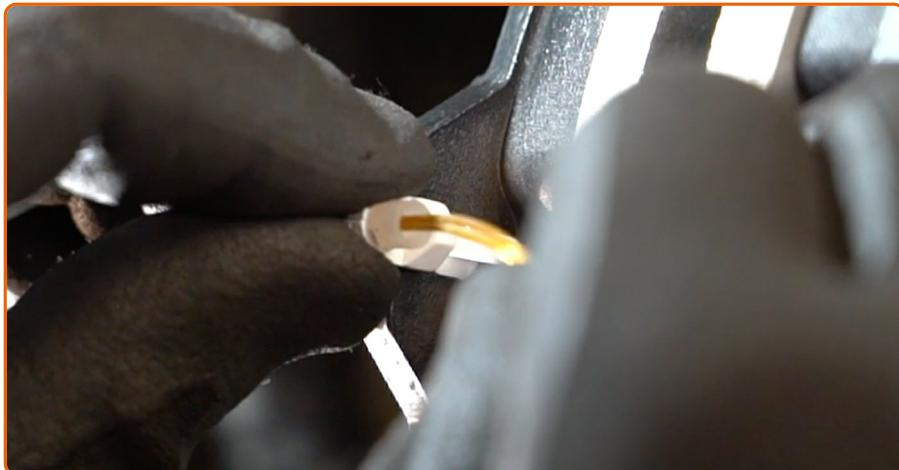
Verbinden Sie den Bremsbelag-Verschleiß-Sensor.
