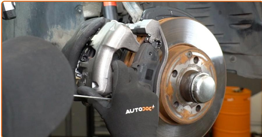
Entfernen Sie den Bremssattel.
