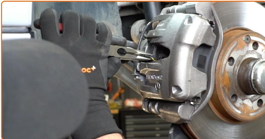
Trennen Sie den Steckverbinder des Verschleißsensors des Bremsbelags. Verwenden Sie eine Rundzange.
