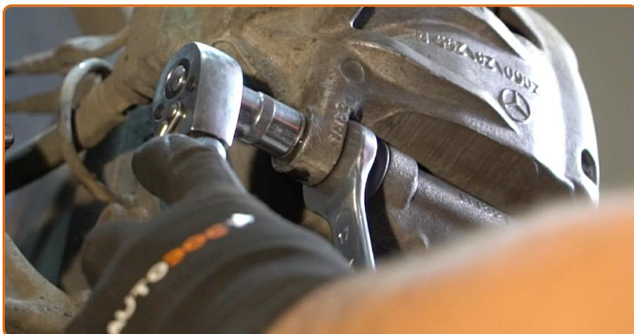
Schrauben Sie die Befestigung des Bremssattels ab. Verwenden Sie Ring-Gabelschlüssel Nr. 17. Verwenden Sie Stecknuss Nr. 13. Verwenden Sie einen Ratschenschlüssel.
