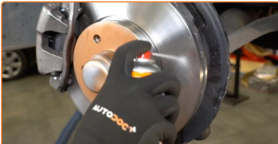
Die Bremsscheibenoberfläche reinigen. Benutzen Sie einen Bremsenreiniger.
