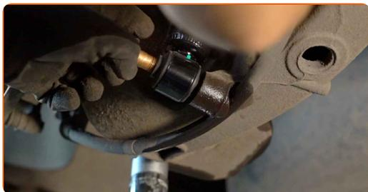
**22** Ziehen Sie den unteren Befestiger des Stoßdämpfers an. Verwenden Sie Stecknuss Nr. E20. Verwenden Sie einen Drehmomentschlüssel. Ziehen Sie ihn mit 130 Nm Drehmoment fest.
