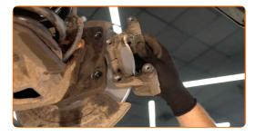
Befestigen Sie die Bremssattelhalterung. Verwenden Sie Stecknuss Nr. E20. Verwenden Sie einen Drehmomentschlüssel. Ziehen Sie ihn mit 100 Nm Drehmoment fest.
