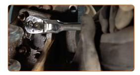
Behandeln Sie die Befestigungen des Radnabenlagers. Benutzen Sie WD-40-Spray.
