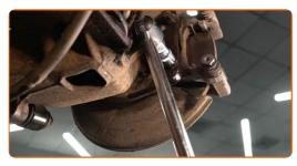
18 Entfernen Sie die Sattelhalterung.
