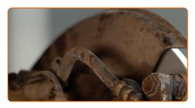
Entfernen Sie den Schmutz von der Schraube zur Befestigung des Bremsschlauchs. Benutzen Sie eine Drahtbürste. Benutzen Sie einen Bremsenreiniger.
