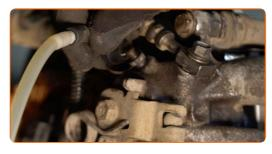
Ziehen Sie die Bremsentlüftungsschraube an. Verwenden Sie Stecknuss Nr. 11. Verwenden Sie einen Ratschenschlüssel.
