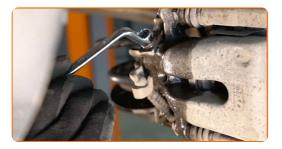
Trennen Sie den Bremsschlauch.
