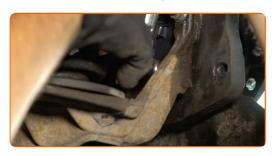
Montieren Sie die Halterung der Montage des Bremsschlauchs und das ABS-Kabel. Verwenden Sie Stecknuss Nr. E8. Verwenden Sie einen Ratschenschlüssel.
