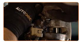
Ziehen Sie den Bremsschlauchhalter fest. Verwenden Sie Stecknuss Nr. 11. Verwenden Sie einen Drehmomentschlüssel. Ziehen Sie ihn mit 40 Nm Drehmoment fest.
