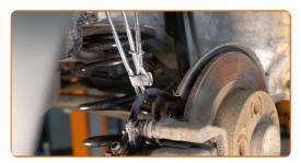
Schrauben Sie den Bremsschlauch vom Bremssattel ab. Verwenden Sie Ring-Gabelschlüssel Nr. 11.
