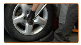
Entfernen Sie den Wagenheber sowie die Unterlegkeile.
