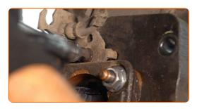
Ziehen Sie das Befestigungselement des Radnabenlagers an. Verwenden Sie Stecknuss Nr. 16. Verwenden Sie einen Drehmomentschlüssel. Ziehen Sie ihn mit 50 Nm Drehmoment fest.+45°
