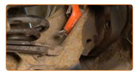
Schrauben Sie die Nabenlagerhalterung ab. Verwenden Sie Stecknuss Nr. 16. Verwenden Sie einen Ratschenschlüssel.
