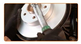
Setzen Sie die Halterung des Bremssattels ein.
