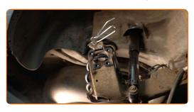
Entfernen Sie das Bremsenabdeckblech.
