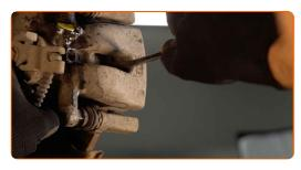
Entfernen Sie den Bremssattel. Benutzen Sie ein Brecheisen.
