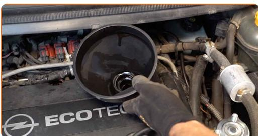
**28** Füllen Sie Öl durch den Einfüllstutzen in den Motor. Erforderliche Menge an Öl: 4.5 l.
