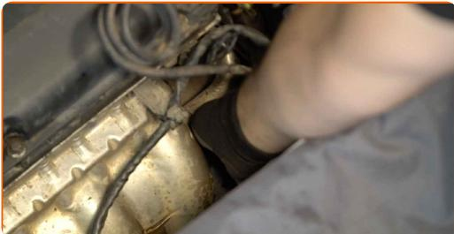
**26** Schrauben Sie die Kappe an. Verwenden Sie Stecknuss Nr. 24. Verwenden Sie einen Drehmomentschlüssel. Ziehen Sie ihn mit 25 Nm Drehmoment fest.
