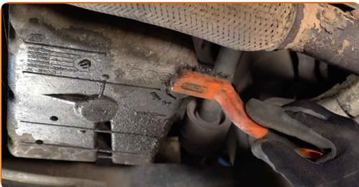
**7** Drehen Sie die Ablassschraube heraus. Verwenden Sie den Torx T45. Verwenden Sie einen Ratschenschlüssel.
