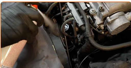
**10** Schrauben Sie den Filtergehäusedeckel zusammen mit dem alten Filterelement ab. Verwenden Sie Stecknuss Nr. 36. Verwenden Sie einen Ratschenschlüssel.
