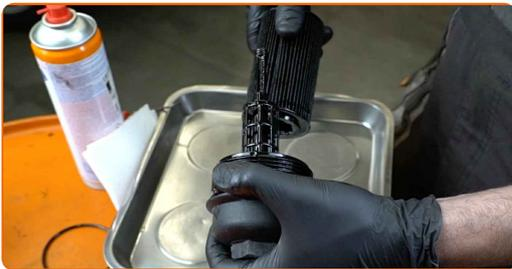
**13** Den Dichtungsring des Ölfilterdeckels entfernen. Verwenden Sie einen flachen Schraubendreher.
