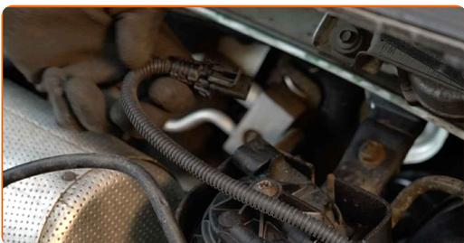
**9** Reinigen Sie die Abdeckung und das Gehäuse des Kraftstofffilters. Verwenden Sie Allzweckreinigungsspray.
