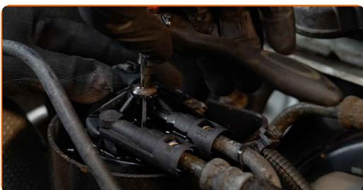
**11** Entfernen Sie den Deckel des Kraftstofffiltergehäuses.
