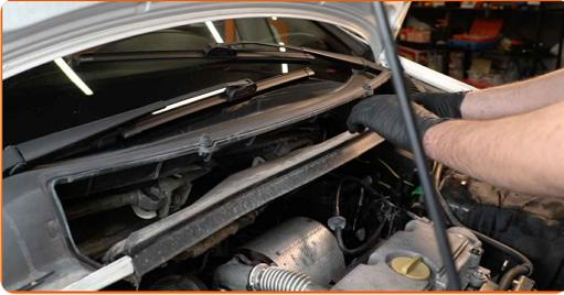
**23** Schraube die Befestigungselemente des Windlaufs unten ein. Verwenden Sie Stecknuss Nr. 10. Verwenden Sie einen Ratschenschlüssel.
