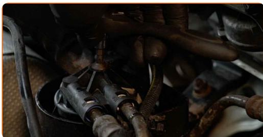
**21** Bringen Sie den Anschluss des Kraftstoffdrucksensors an.
