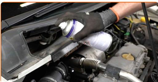
**6** Schraube die Befestigungselemente des Windlaufs unten ab. Verwenden Sie Stecknuss Nr. 10. Verwenden Sie einen Ratschenschlüssel.
