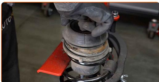
**41** Ziehen Sie die Federbeinkolbenstangenmutter an. Verwenden Sie Stecknuss Nr. 18. Verwenden Sie Inbusschlüssel Nr. H6. Verwenden Sie einen Drehmomentschlüssel. Ziehen Sie ihn mit 50 Nm Drehmoment fest.
