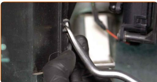
**11** Entfernen Sie den Gehäusedeckel des Innenraumfilters.
