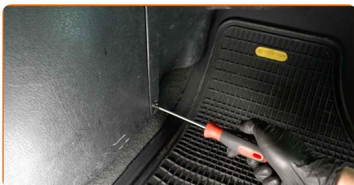
**2** Eemaldage kindalaeka korpuse alumised klambrid. Verwenden Sie einen Lösehebel, um die Clips zu entfernen.
