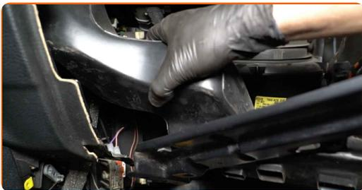
**9** Lösen Sie die Befestigungsclips der Innenraumfilterabdeckung. Verwenden Sie einen Lösehebel, um die Clips zu entfernen.
