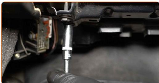
**8** Entferne die Komponenten des Lüftungskanals.
