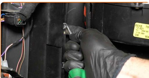
**10** Lösen Sie die Clips der Innenraumfilterabdeckung.
