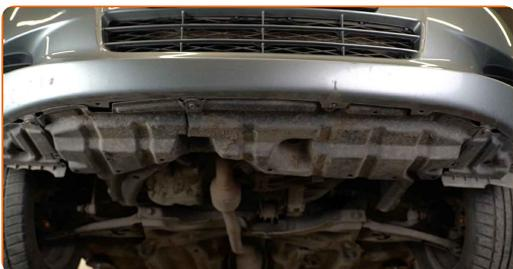
**3** Drehen Sie die unteren Befestigungen der Stoßstange auf. Verwenden Sie Stecknuss Nr. 10. Verwenden Sie einen Ratschenschlüssel.
