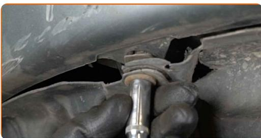
**4** Entfernen Sie die seitlichen Halteklammern der Stoßstange. Verwenden Sie einen Kreuzschlitzschraubendreher. Verwenden Sie einen Lösehebel, um die Clips zu entfernen.
