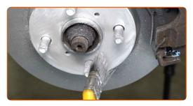
Die Bremsscheibenoberfläche reinigen. Benutzen Sie einen Bremsenreiniger.
