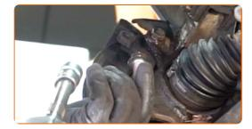
16 Entfernen Sie die Sattelhalterung.
