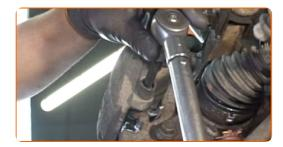
Installieren Sie die Staubschutzkappen der Bremssattel-Führungsstifte.
