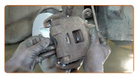
Ziehen Sie die Bremssattelbefestigungen fest. Verwenden Sie Inbusschlüssel Nr. H7. Verwenden Sie einen Drehmomentschlüssel. Ziehen Sie ihn mit 34 Nm Drehmoment fest.
