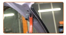
Bringen Sie die neue Gasfeder des Kofferraumdeckels an.
