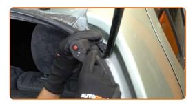
Schrauben Sie die Befestigung ab, die die Gasfeder mit dem Kofferraumdeckel verbindet. Verwenden Sie Stecknuss Nr. 10. Verwenden Sie einen Ratschenschlüssel.
