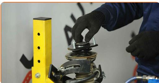
**28** Dekomprimieren Sie die Feder.
