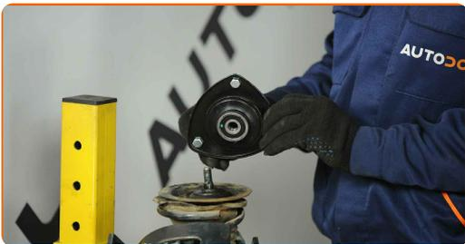
**25** Ziehen Sie die Federbeinkolbenstangenmutter an. Verwenden Sie Stecknuss Nr. 17. Verwenden Sie einen Drehmomentschlüssel. Ziehen Sie ihn mit 33 Nm Drehmoment fest.
