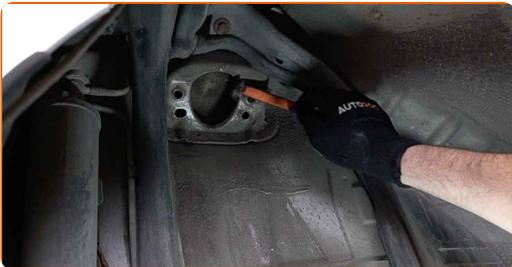
**31** Installieren Sie das Federbein am Radlauf.
