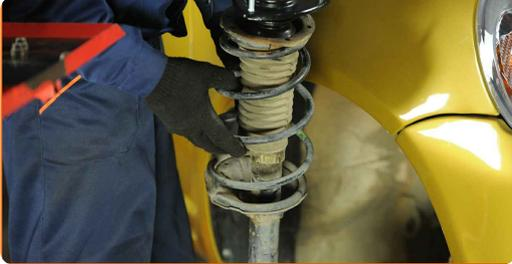
**30** Reinigen Sie die Anbringungssitze des Federbeins. Benutzen Sie eine Drahtbürste. Benutzen Sie WD-40-Spray.
