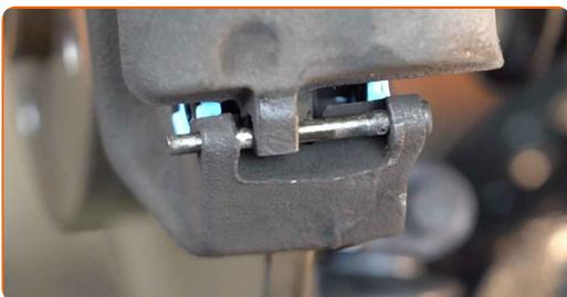
**21** Behandeln Sie die Bremssattel-Führungstifte. Verwenden Sie das Bremssattelführungsbolzen-Fett.
