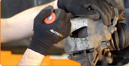
**9** Schrauben Sie die Befestigung des Bremssattels ab. Verwenden Sie Ring-Gabelschlüssel Nr. 17. Verwenden Sie Stecknuss Nr. 14.
