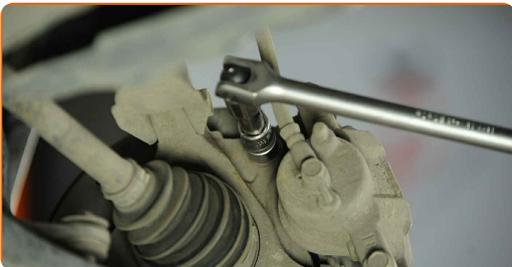
**10** Entfernen Sie den Bremssattel.
