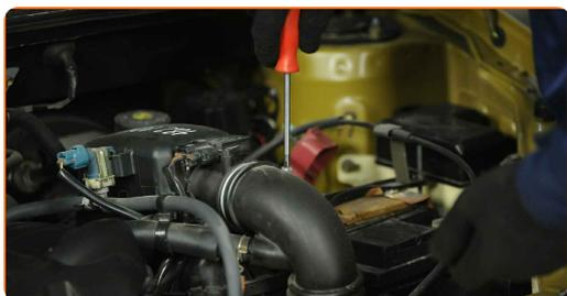
**4** Trennen Sie das Luftansaugrohr vom Luftfilter-Gehäuse.
