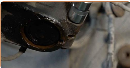
**55** Die Keilwellen des CV-Gelenks der Antriebswelle reinigen. Benutzen Sie eine Drahtbürste. Benutzen Sie WD-40-Spray.
