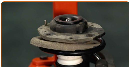
**47** Ziehen Sie die Federbeinkolbenstangenmutter an. Verwenden Sie Stecknuss Nr. 22. Verwenden Sie Inbusschlüssel Nr. H7. Verwenden Sie einen Drehmomentschlüssel. Ziehen Sie ihn mit 49 Nm Drehmoment fest.
