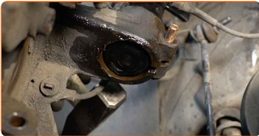
**54** Schrauben Sie das Befestigungselement ein, das das Federbein mit dem Achsschenkel verbindet. Verwenden Sie Stecknuss Nr. 16.
