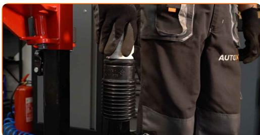
**44** Installieren Sie die Feder am Stoßdämpfer.
