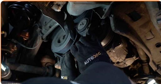
9 Setzen Sie den Keilrippenriemen auf die Spannrolle auf.
