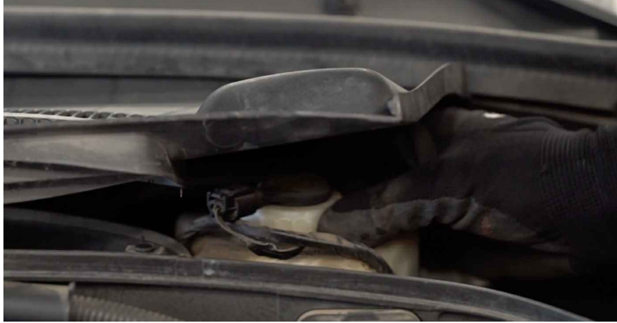
31 Installieren Sie die Schutzabdeckung.
