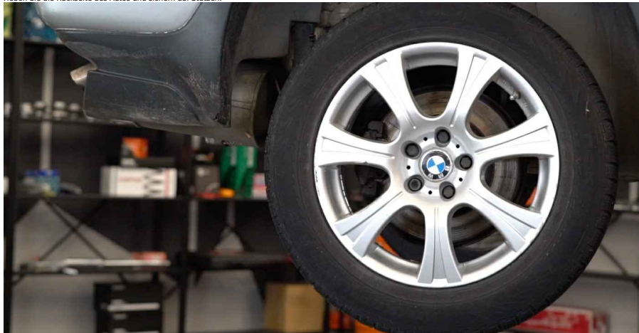
8 Schrauben Sie die Radbolzen heraus.
