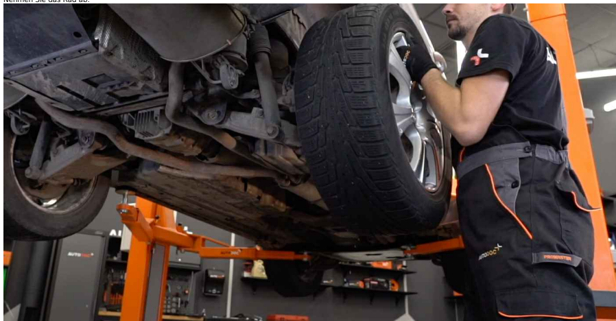
10 Verteilen Sie die Bremsbeläge. Benutzen Sie ein Brecheisen.
