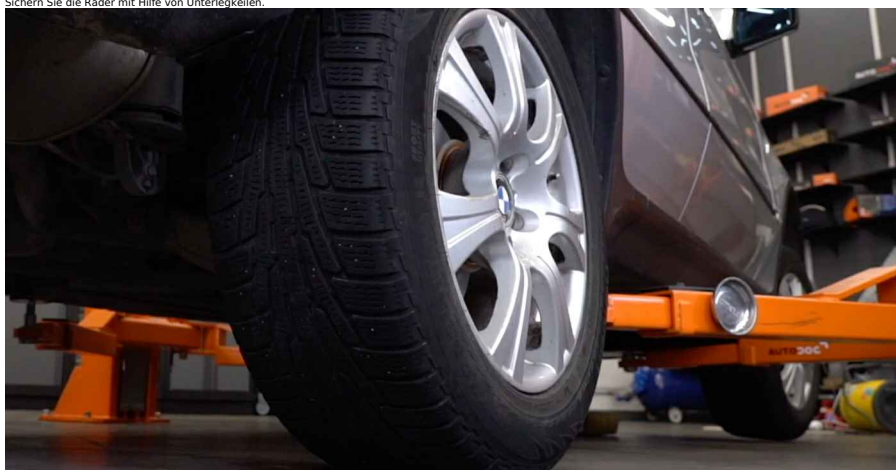
6 Lösen Sie die Radhalterungsschrauben. Verwenden Sie eine Schlagnuss für Felgen # 19.
