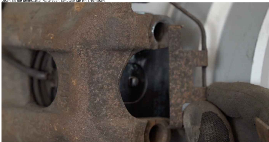
14 Entfernen Sie den Bremssattel.
