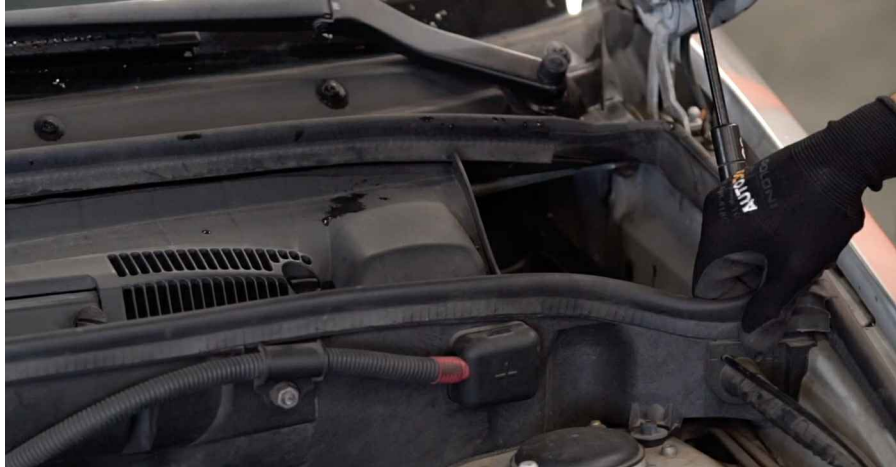
3 Entfernen Sie den Gummistreifen.
