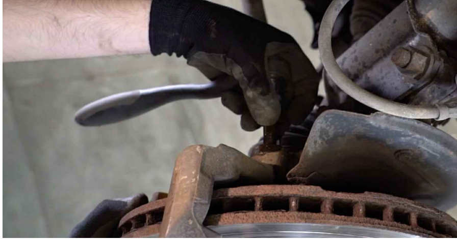
19 Die Bremsscheibenoberfläche reinigen. Benutzen Sie eine Drahtbürste. Benutzen Sie WD-40-Spray.
