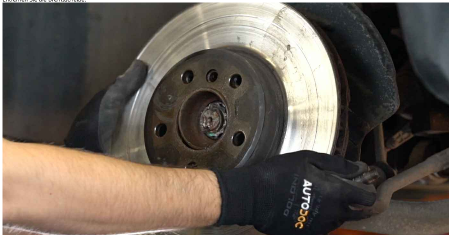
22 Reinigen Sie die Nabe. Benutzen Sie eine Drahtbürste. Behandeln Sie die Kontaktfläche. Benutzen Sie ein Kupferschmiermittel.
