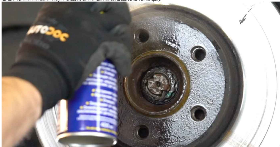
20 Lösen Sie die Befestigung der Bremsscheibe. Verwenden Sie den Torx T30. Verwenden Sie einen Schlagschrauber.
