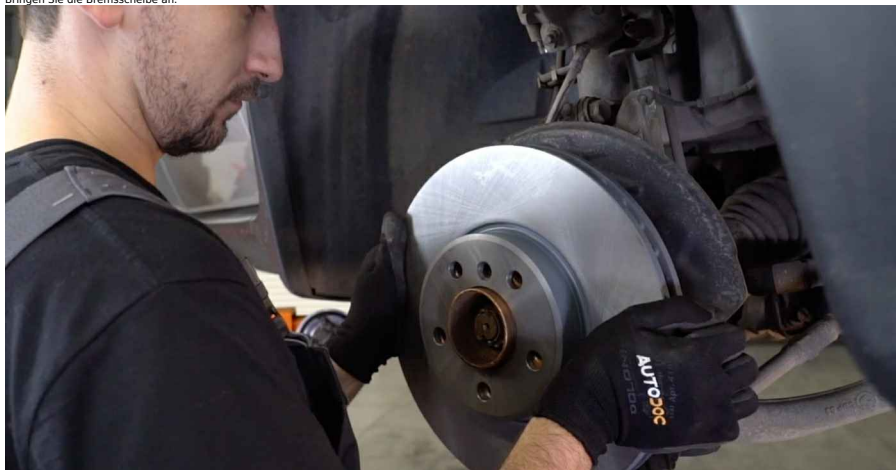
24 Ziehen Sie die Befestigung der Bremsscheibe fest. Verwenden Sie den Torx T30. Verwenden Sie einen Drehmomentschlüssel. Ziehen Sie ihn mit 16 Nm Drehmoment fest.
