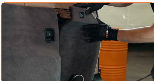
**80** Setzen Sie die untere Kofferraumverkleidung ab.
