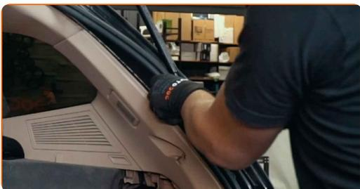
**8** Entfernen Sie die Kunststoffschutzabdeckung der Karosserie.
