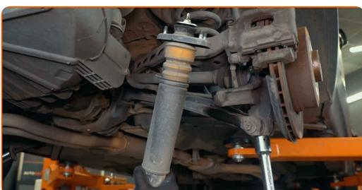
**38** Greifen Sie den Stoßdämpfer mit einem Schraubstock.
