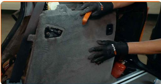
**62** Schrauben Sie das Befestigungselement der Seitenauskleidung des Kofferraums ein. Verwenden Sie einen Kreuzschlitzschraubendreher.
