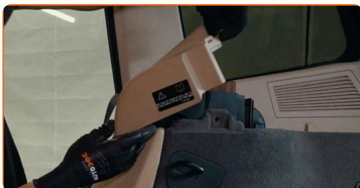
**11** Trennen Sie Hinterseitenverkleidung des Kofferraums.
