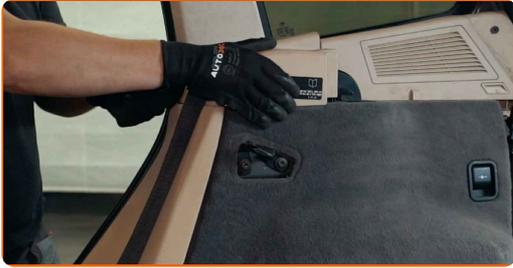
**72** Bringen Sie die Hinterseitenverkleidung des Kofferraums an.
