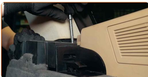
**13** Entferne die Clips der Hutablage. Verwenden Sie den Torx T25. Verwenden Sie einen Ratschenschlüssel.
