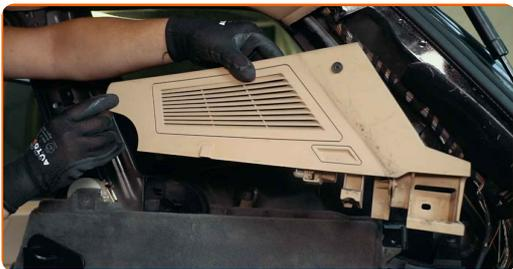
**21** Entfernen Sie die Clips der Seitenauskleidung des Kofferraums. Verwenden Sie einen Zierleistenkeil.
