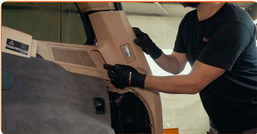
**77** Schrauben Sie die Befestigungen der Kunststoffschutzabdeckung der Karosserie ein. Verwenden Sie einen Kreuzschlitzschraubendreher.
