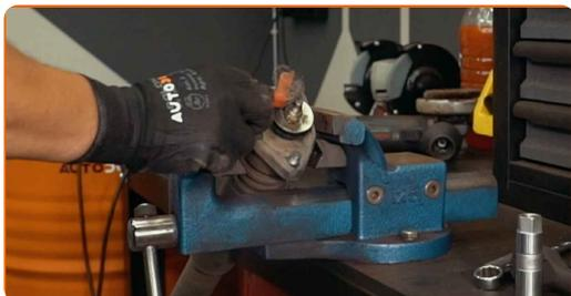
**40** Entfernen Sie die Befestigung der Stoßdämpferkolbenstange. Verwenden Sie einen Stoßdämpfer Steckschlüsseleinsatz DDN°6. Verwenden Sie Stecknuss Nr. 16. Verwenden Sie einen Ratschenschlüssel.
