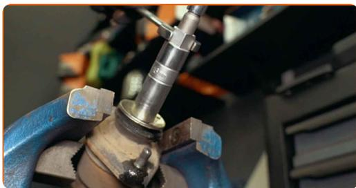
**41** Entfernen Sie die Stoßdämpferhalterung, die Manschette und den Stoßstopp.
