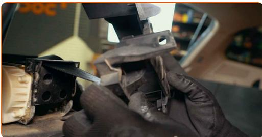
**20** Entfernen Sie die Seitenabdeckung aus Kunststoff.
