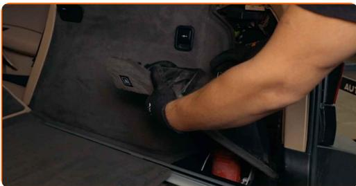
**6** Schrauben Sie die Befestigungen der Kunststoffschutzabdeckung der Karosserie ab. Verwenden Sie einen Kreuzschlitzschraubendreher.
