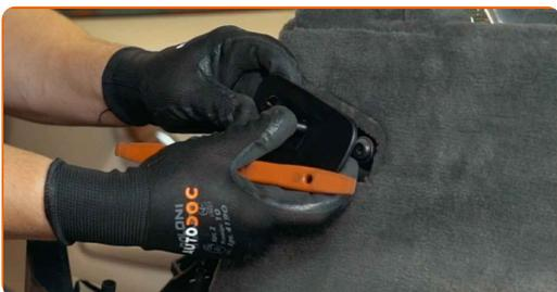
**22** Schrauben Sie das Befestigungselement der Seitenauskleidung des Kofferraums heraus. Verwenden Sie einen Kreuzschlitzschraubendreher.
