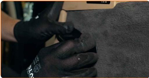
**74** Bringen Sie die Clips der Seitenauskleidung des Kofferraums an.
