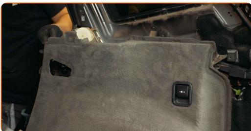
**24** Entfernen Sie die Schutzkappe der Stoßdämpferhalterung.
