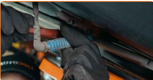
**14** Trennen Sie die ABS Sensorverdrahtung. Verwenden Sie einen flachen Schraubendreher.
