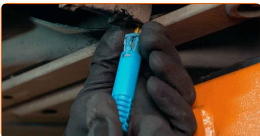
**17** Verbinden Sie das ABS mit der Sensorverdrahtung.
