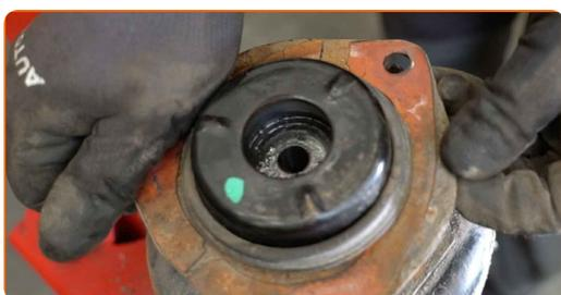
**28** Die Staubkappe des Stoßdämpfers und den Anschlagpuffer entfernen.
