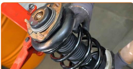
**41** Installieren Sie das Federbein am Radlauf.
