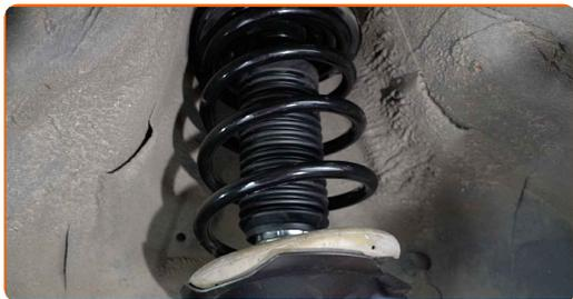
**42** Befestigen Sie den Stoßdämpfer am hinteren Achsschenkel.
