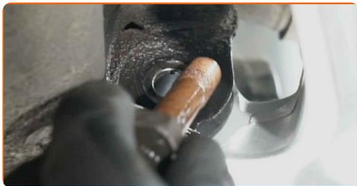
**20** Verbinden Sie das Kugelgelenk mit dem Achsschenkel.
