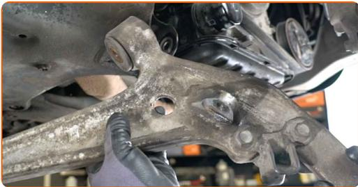
**17** Reinigen Sie die Montagesitze des Querlenkers. Benutzen Sie eine Drahtbürste. Benutzen Sie WD-40-Spray.
