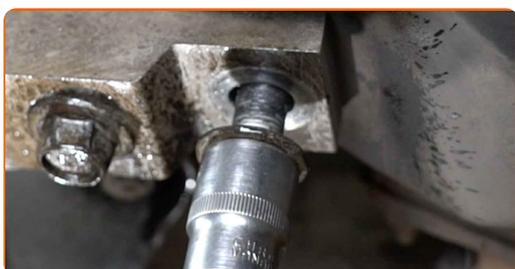
**15** Entfernen Sie die Befestigungsschrauben (3 Teile).
