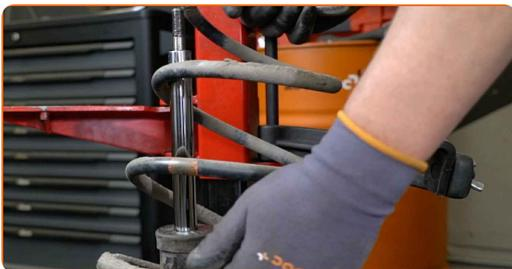
**29** Installieren Sie die Feder am Stoßdämpfer.
