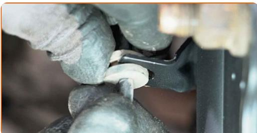
**43** Befestigen Sie den Bremsschlauch am Federbein.
