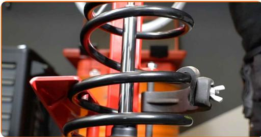
**31** Installieren Sie die Staubschutzmanschette und den Anschlagpuffer auf dem neuen Stoßdämpfer.
