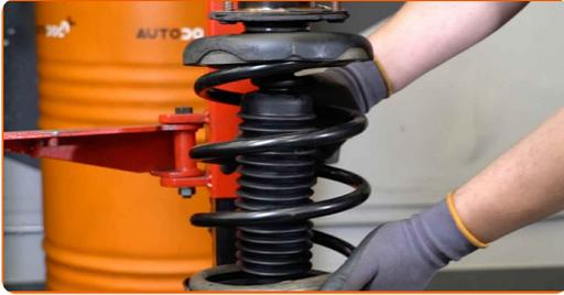
**37** Installieren Sie das Federbein am Radlauf.
