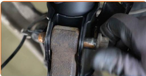
**41** Ziehen Sie die unteren Befestigungen an, die das Federbein mit dem Achsschenkel verbinden. Verwenden Sie Ring-Gabelschlüssel Nr. 17. Verwenden Sie Stecknuss Nr. 19. Verwenden Sie einen Drehmomentschlüssel. Ziehen Sie ihn mit 140 Nm Drehmoment fest.
