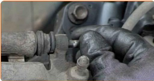
**22** Ziehen Sie die Bremssattelbefestigungen fest. Verwenden Sie Stecknuss Nr. 14. Verwenden Sie einen Drehmomentschlüssel. Ziehen Sie ihn mit 32 Nm Drehmoment fest.
