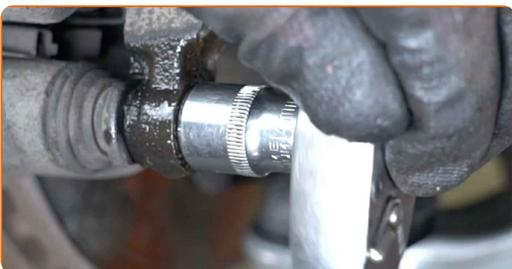
**10** Entfernen Sie die Befestigungsschrauben.
