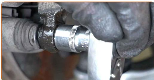
**10** Entfernen Sie die Befestigungsschrauben.
