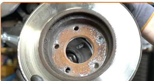
**19** Reinigen Sie die Nabe. Benutzen Sie eine Drahtbürste.
