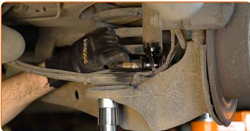
**10** Lösen Sie den unteren Teil des Stoßdämpfers. Benutzen Sie ein Brecheisen.
