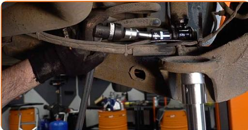
**9** Entfernen Sie die Befestigungsschraube.
