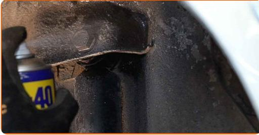
**8** Schrauben Sie den unteren Befestiger des Stoßdämpfers ab. Verwenden Sie Stecknuss Nr. 21. Benutzen Sie ein Brecheisen. Verwenden Sie ein Windeisen.
