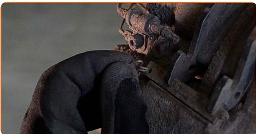
**10** Entfernen Sie die Halteklammer der Bremsbeläge. Benutzen Sie ein Brecheisen. Verwenden Sie einen Gummi-Hammer.
