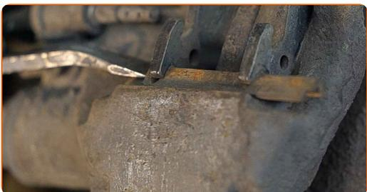
**11** Entfernen Sie die Bremsbeläge. Benutzen Sie ein Brecheisen.
