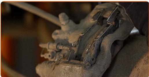
**9** Entfernen Sie die Haltefeder des Bremsbelags.
