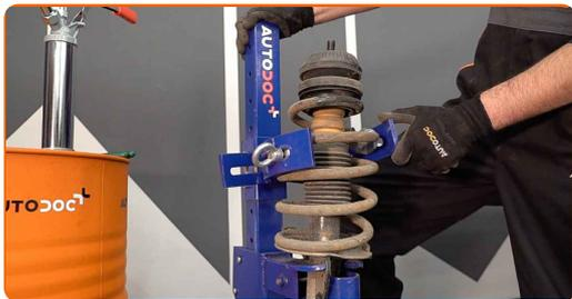
**31** Reinigen Sie die Stoßdämpferstange. Benutzen Sie WD-40-Spray.
