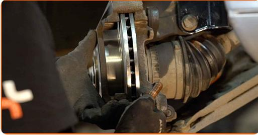
**25** Befestigen Sie die Bremssattelhalterung. Verwenden Sie Stecknuss Nr. 21. Verwenden Sie einen Drehmomentschlüssel. Ziehen Sie ihn mit 162 Nm Drehmoment fest.
