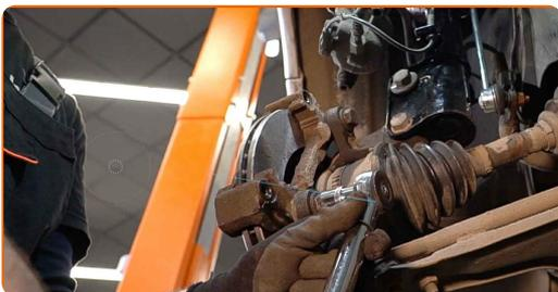
**26** Behandeln Sie den Bremssattel-Kolben. Benutzen Sie WD-40-Spray.
