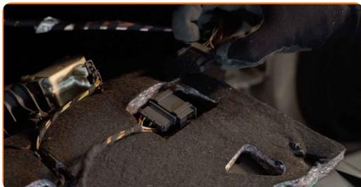
**8** Entfernen Sie den Gehäusedeckel des Innenraumfilters.
