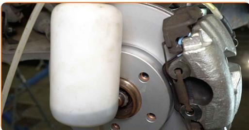
**30** Entlüften Sie das Bremssattelsystem.
