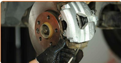
**28** Lösen Sie die Bremsentlüftungsschraube. Verwenden Sie einen offenen Ringschlüssel #11.
