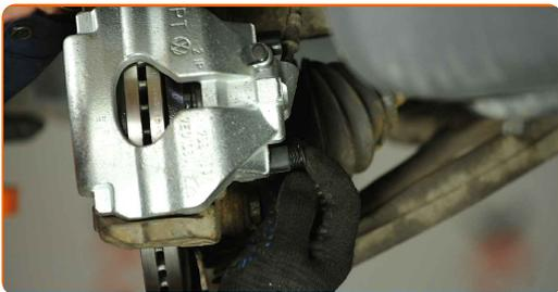
**27** Bauen Sie die Bremssattel-Haltefeder ein. Benutzen Sie ein Brecheisen.
