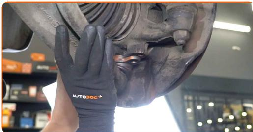
**16** Schrauben Sie das Befestigungselement ein, das das Kugelgelenk mit dem Achsschenkel verbindet. Verwenden Sie Stecknuss Nr. 19. Verwenden Sie einen Ratschenschlüssel.
