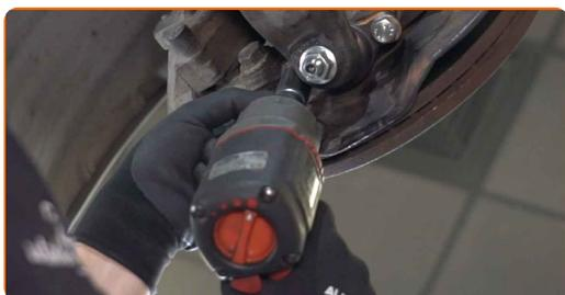
**17** Schrauben Sie das Befestigungselement ein, das das Traggelenk mit dem Querlenker verbindet. Verwenden Sie Stecknuss Nr. 21. Verwenden Sie einen Ratschenschlüssel.
