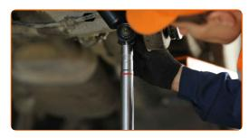
Entfernen Sie die Befestigungsschraube.
