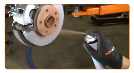
Die Bremsscheibenoberfläche reinigen. Benutzen Sie einen Bremsenreiniger.
