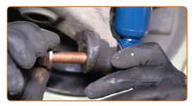
Ziehen Sie den unteren Befestiger des Stoßdämpfers an. Verwenden Sie Ring-Gabelschlüssel Nr. 21. Verwenden Sie Stecknuss Nr. 21. Verwenden Sie einen Drehmomentschlüssel. Ziehen Sie ihn mit 120 Nm Drehmoment fest.+90°
