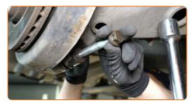
Entfernen Sie den Träger unter dem Arm.
