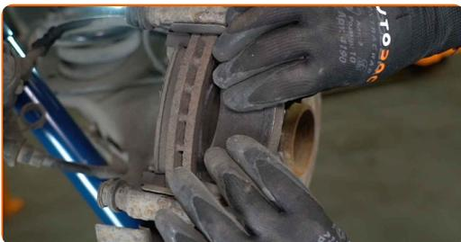
**Austausch: Bremsbeläge – VW Transporter V Bus (7HB, 7HJ, 7EB, 7EJ, 7EF, 7EG, 7HF, 7EC). Tipp von AUTODOC-Experten:**
