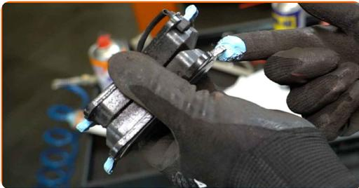
**Austausch: Bremsbeläge – VW Transporter V Bus (7HB, 7HJ, 7EB, 7EJ, 7EF, 7EG, 7HF, 7EC). AUTODOC-Experten empfehlen:**
