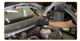
Heben Sie die Windabweiserabdeckung an und entfernen Sie dieses.
