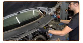
Entfernen Sie die Kappe des Federbeinstützlagers.
