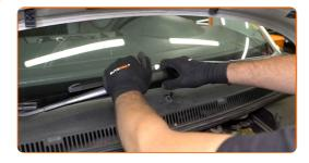
Entfernen Sie die Dichtung der Windabweiserabdeckung.
