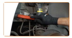
Schrauben Sie das Befestigungselement heraus, das die Druckstange mit dem Federbein verbindet. Verwenden Sie Stecknuss Nr. 18. Verwenden Sie einen Ratschenschlüssel.
