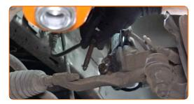
Lösen Sie das untere Befestigungselement, dass das Federbein mit dem Achsschenkel verbindet. Verwenden Sie eine spezielle Schraubnuss, um den Stoßdämpfer zu entfernen. Verwenden Sie einen Ratschenschlüssel.
