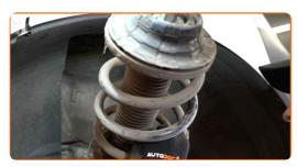
Stellen Sie das Dämpferbein auf das Federspannwerkzeug.
