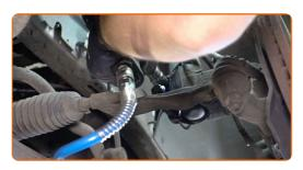
Entfernen Sie die Befestigungsschrauben.
