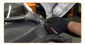
Reinigen Sie die Befestigungen der Wischerarme. Benutzen Sie eine Drahtbürste. Benutzen Sie WD-40-Spray.
