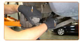
Die Befestigungselemente, die das Federbein mit dem Achsschenkel verbinden, reinigen. Benutzen Sie eine Drahtbürste. Benutzen Sie WD-40-Spray.
