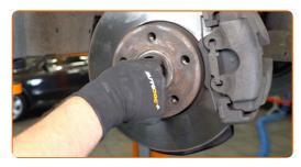
Schrauben Sie die Mutter an die Gelenkwelle. Verwenden Sie Stecknuss Nr. 30. Verwenden Sie einen Ratschenschlüssel.
