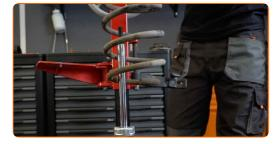
Installieren Sie die Feder am Stoßdämpfer.
