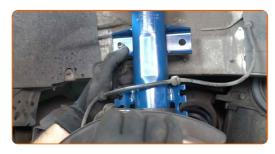
Ziehen Sie das Befestigungselement an, das die Druckstange mit dem Federbein verbindet. Verwenden Sie Stecknuss Nr. 18. Verwenden Sie einen Drehmomentschlüssel. Ziehen Sie ihn mit 60 Nm Drehmoment fest.+45°
