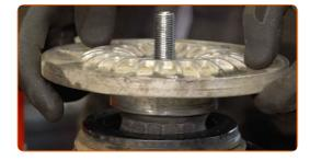
Ziehen Sie die Federbeinkolbenstangenmutter an. Verwenden Sie Stecknuss Nr. 21. Verwenden Sie Inbusschlüssel Nr. H7. Verwenden Sie einen Drehmomentschlüssel. Ziehen Sie ihn mit 80 Nm Drehmoment fest.
