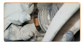
Entfernen Sie den Träger unter dem Achsschenkel.
