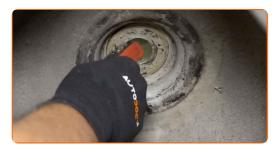
Installieren Sie das Federbein am Radlauf.
