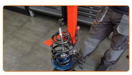
Installieren Sie die Manschette und eine Stoßstopp auf den Stoßdämpfer.
