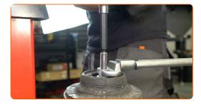
Dekomprimieren Sie die Feder.
