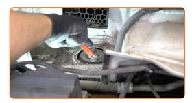
Lösen Sie die oberen Befestigungselemente des Federbeinstützlagers. Verwenden Sie Inbusschlüssel Nr. H7. Verwenden Sie Stecknuss Nr. 21. Verwenden Sie einen Ratschenschlüssel.
