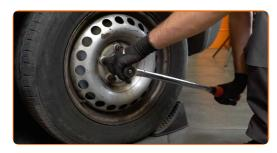
Die Antriebswellenmutter festziehen. Verwenden Sie Stecknuss Nr. 30. Verwenden Sie einen Drehmomentschlüssel. Ziehen Sie ihn mit 200 Nm Drehmoment fest.
