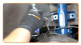
68 Montieren Sie den Querlenker.
