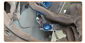
Schrauben Sie die Befestigungen ein, die das Federbein mit dem Achsschenkel verbinden. Verwenden Sie Stecknuss Nr. 18. Verwenden Sie einen Ratschenschlüssel.
