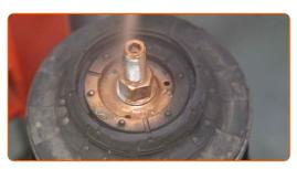
Entfernen Sie das zusammengebaute Federbein.
