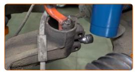
Befestigen Sie das Dämpferbein auf dem Achsschenkel.
