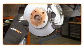
Die Bremsscheibenoberfläche reinigen. Benutzen Sie einen Bremsenreiniger.
