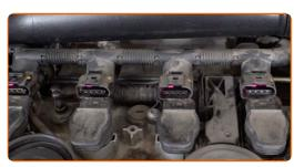
Heben Sie die Zündspule an. Benutzen Sie ein Brecheisen.
