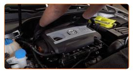
Lösen Sie die Steckverbindung von den Zündspulen.
