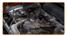
Behandeln Sie den Zündspulenanschluss mit einem Elektronikspray. Das Spray wird die elektrischen Kontakte vor Korrosion und Oxidation schützen und den Kontaktwiderstand reduzieren.
