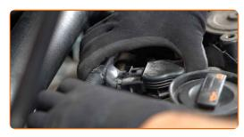
Installieren Sie die Motorabdeckung und sichern Sie diese. Stellen Sie sicher, dass Sie dabei das Klicken hören, welches entsteht, wenn sich diese in der korrekten Position befindet.
