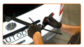
Austausch: Scheibenwischer – VW Transporter T5 Bus (7HB, 7HJ, 7EB, 7EJ, 7EF, 7EG, 7HF, 7EC). Tipp:
