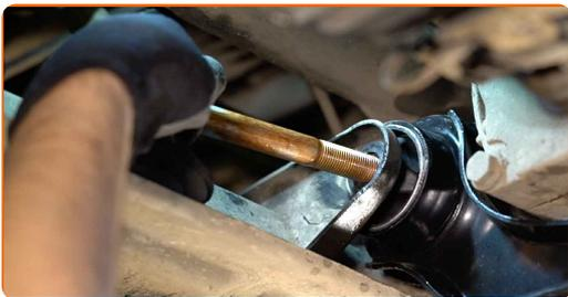
**13** Schrauben Sie die Befestigungen der Motoraufhängung ein. Verwenden Sie Inbusschlüssel Nr. H10. Verwenden Sie Stecknuss Nr. 21. Verwenden Sie einen Ratschenschlüssel.
