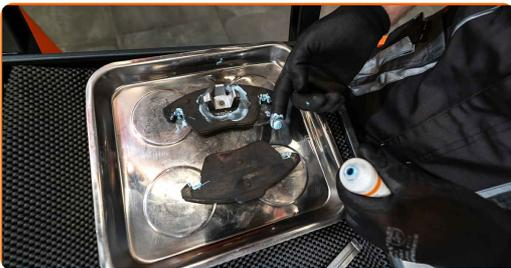
**22** Bauen Sie den Bremssattel zusammen mit den Bremsbelägen ein.
