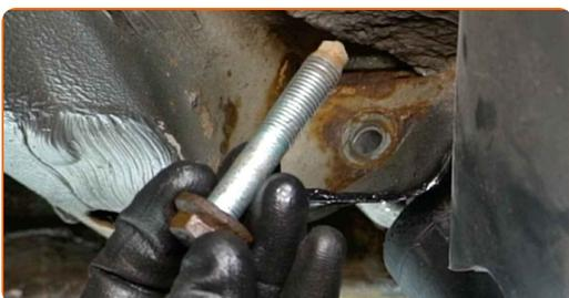
**15** Den Stoßdämpfer entfernen.
