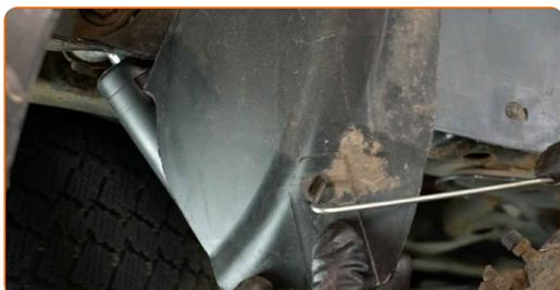
**12** Reinigen Sie die obere Befestigung des Stoßdämpfers. Benutzen Sie eine Drahtbürste. Benutzen Sie WD-40-Spray.
