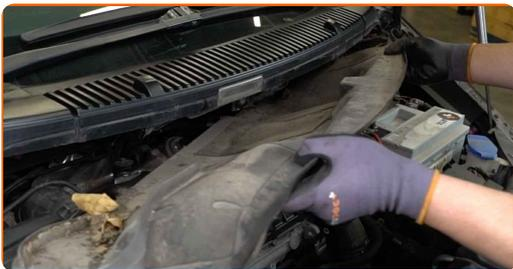
**6** Drücken Sie auf die Halterung des Innenraumfilters, um sie zu lösen.
