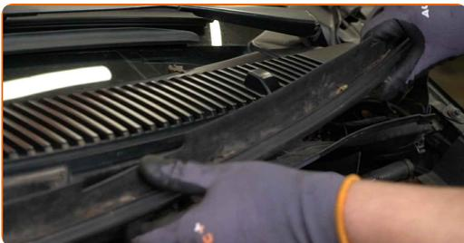
**4** Schrauben Sie die Befestigung der Kunststoffplatte ab. Verwenden Sie Stecknuss Nr. 10. Verwenden Sie einen Ratschenschlüssel.
