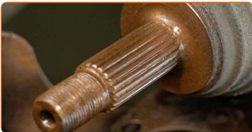
**48** Reinigen Sie den Kugelgelenk-Montagesitz. Benutzen Sie eine Drahtbürste. Benutzen Sie WD-40-Spray.
