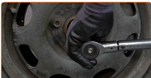
**82** Ziehen Sie die Radschrauben unter Verwendung eines Kreuzmusters an. Verwenden Sie eine Schlagnuss für Felgen # 17. Verwenden Sie einen Drehmomentschlüssel. Ziehen Sie ihn mit 110 Nm Drehmoment fest.
