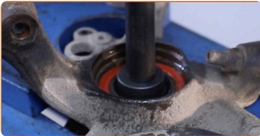
**34** Reinigen Sie den Sicherungsring des Radnabenlagers. Benutzen Sie eine Drahtbürste. Benutzen Sie WD-40-Spray.
