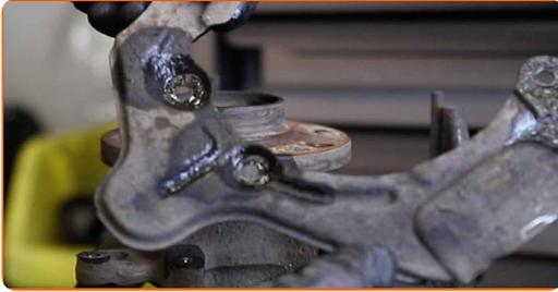
**33** Entfernen Sie die Radnabe vom Achsschenkel. Verwenden Sie einen Druckstücksatz mit Ein-/Auspresswerkzeug.
