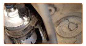
Den Flüssigkeitsbehälter unter dem Kraftstofffilter entfernen.
