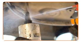
Trennen Sie die Kraftstoffversorgungsleitungen vom Kraftstofffilter. Benutzen Sie ein Brecheisen.
