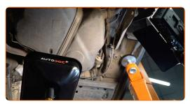
Reinigen Sie die Befestigungen der Kraftstoff-Zuleitungen. Verwenden Sie Allzweckreinigungsspray.
