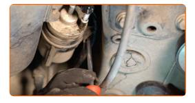
Reinigen Sie die Kraftstoffleitungen. Verwenden Sie Allzweckreinigungsspray.
