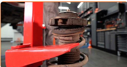
**29** Behandeln Sie die Federbeinstange. Benutzen Sie eine Drahtbürste. Benutzen Sie WD-40-Spray.
