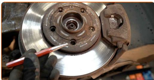
**19** Lösen Sie das Befestigungselement, welches die Antriebswelle mit der Radnabe verbindet. Verwenden Sie die 12-Kant-Stecknuss Nr. 30.
