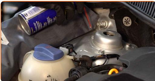
**4** Lösen Sie die oberen Befestigungselemente des Federbeinstützlagers. Verwenden Sie Stecknuss Nr. 13. Verwenden Sie einen Ratschenschlüssel.
