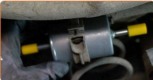
**Austausch: Kraftstofffilter – VW Polo III Van Kasten / Kombi (6V5). AUTODOC-Experten empfehlen:**
