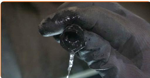
**12** Verbinden Sie die Kraftstoffversorgungsleitungen zum Kraftstofffilter.
