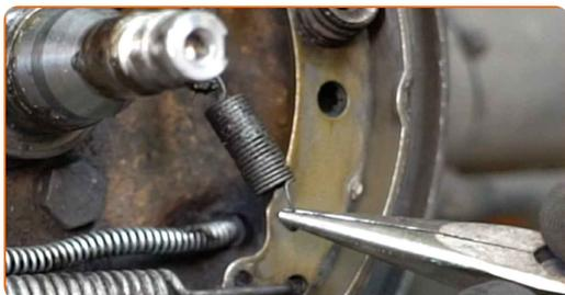
**13** Entfernen Sie die obere Rückholfeder der Bremsbacken. Verwenden Sie eine Rundzange.
