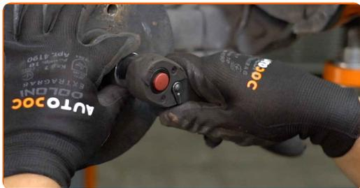
**10** Entfernen Sie die an der Radnabenlagereinheit montierte Bremstrommel.
