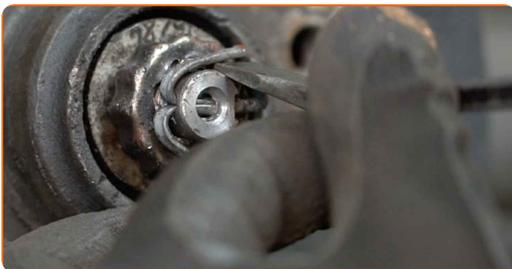
**9** Schrauben Sie die Nabenmutter ab. Verwenden Sie Stecknuss Nr. 30. Verwenden Sie einen Ratschenschlüssel.
