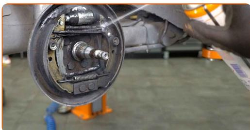
**12** Entfernen Sie die Niederhaltefeder. Verwenden Sie eine Rundzange.
