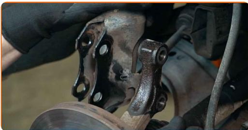
15 Schrauben Sie die obere Befestigung des Federbeins ab.
