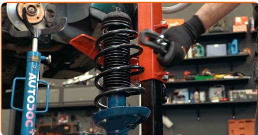
**33** Entfernen Sie das zusammengebaute Federbein.
