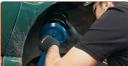
**37** Befestigen Sie das Dämpferbein auf dem Achsschenkel.
